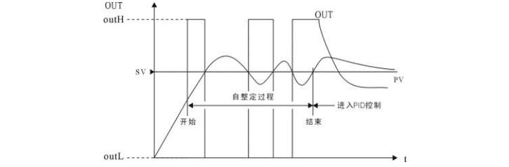
在自整定过程中，可以通过 **AT**（▼）键组合停止自整定。设置为 *oFF* 时，无自整定过程。
